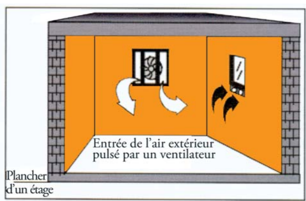
Ventilation par air pulsé
